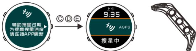
搜索GPS信号时，请在户外空旷处，将手表GPS天线朝上，保持静止。在运动模式，按[E]键手表进入搜星画面。如果收到GPS信号，手表显示<搜星成功>和心率值。
