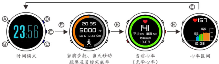
在心率界面，心率符号 闪烁表示光学心率计正在搜索心率信号。显示心率值则表示搜索成功；如果搜索一分钟手表仍不显示心率值表示搜索失败。
